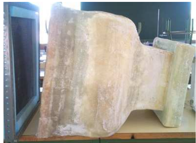
Figura 3. Aspecto exterior del perfil del cono de contracción
